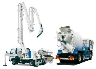
コンクリートミキサー車 コンクリートポンプ車
